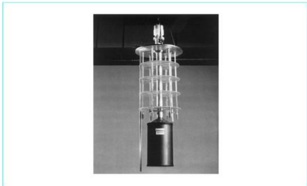
Figure III.10. Limiteur résistif : prototype Alcatel Alsthom Recherche, [11].
